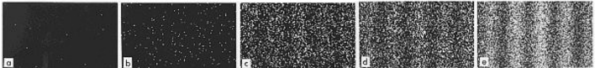
Рис. 3. Результаты двухщелевого эксперимента (by Dr. Tonomura) по выпуску одиночных электронов. Число электронов: а) 10 б) 200 с) 6000 д) 40000 е) 140000
